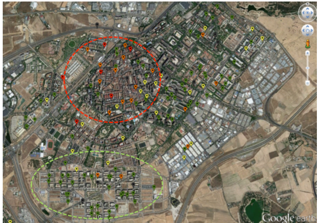
Situación de pérdidas de los centros de una zona geográfica de la red de Iberdrola Distribución (coloreados según su gravedad). Como puede observarse la mayoría de los centros de transformación de la zona superior izquierda tienen elevadas pérdidas, mientras que en los de la zona inferior izquierda las pérdidas se encuentran en valores razonables.
